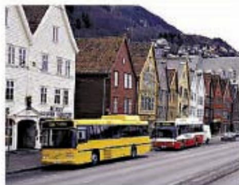
Wielkim stylizacyjnym wyzwaniem, przed jakim stanęli twórcy gazowych 7000, było umieszczenie na dachu butli w taki sposób, by nie raziły one swym wyglądem i równocześnie idealnie łączyły się z sylwetką bazowych odmian.
