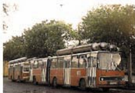
A oto najbardziej bodaj oryginalna konstrukcja z wykorzystaniem gazu do napędu autobusu urzekająca „prostym, surowym pięknem”.
